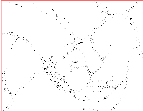
Slika 13: Indeksirane detaljne točke na planu kao produkt automatske obrade geodetskih podataka, ali bez upotrebe kodiranja - nema međusobne topološke veze te za finaliziranje plana treba voditi skicu
