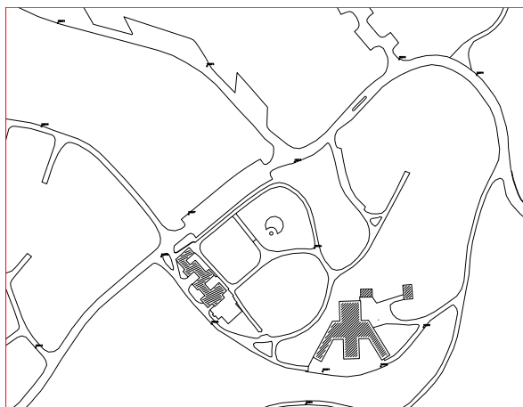
Slika 15: Finalizirana površina plana kojoj se naknadno upisuje opis, koordinatna mreža itd. - primjetan je broj operacija koje su potrebne da se ovakav proizvod dobije na klasičan način (slika 13.) i kodiranjem detalja (slika 14.). Prikazani primjeri planova su vlasništvo tvrtke 'MJERNIK-ZAGREB' d.o.o.
