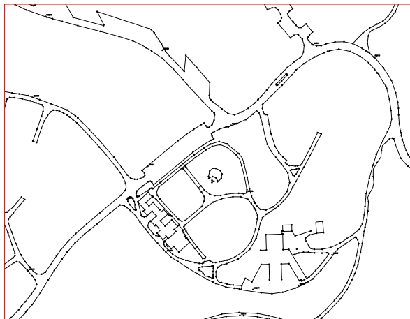
Slika 14: Primarni grafički izlaz kao produkt automatske obrade podataka, ali uz upotrebu kodiranog snimanja detalja - jasno se vide obrisi svih objekata te nam terenska skica kao dodatna dešifraža nije potrebna
